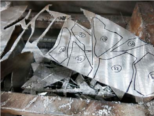
Ausschneiden der Einzelteile mit Plasmastrahl
