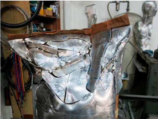
Haftschweissen der Teilbleche
