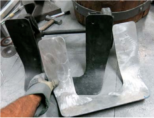
Geformtes und geschweisstes Aufladelement
