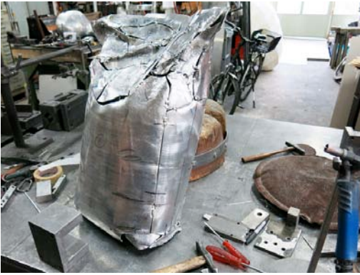
Anpassen der Einzelteile und Haftschiessen
