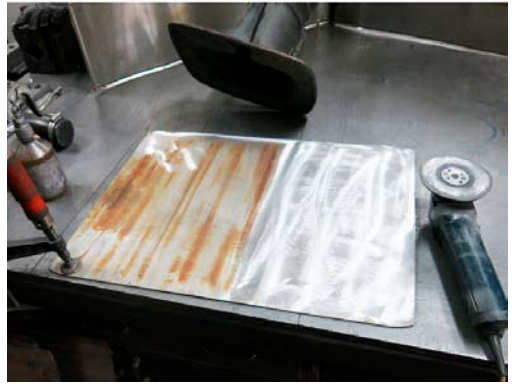
Reinigung und schleifen der Aluminiumbleche
